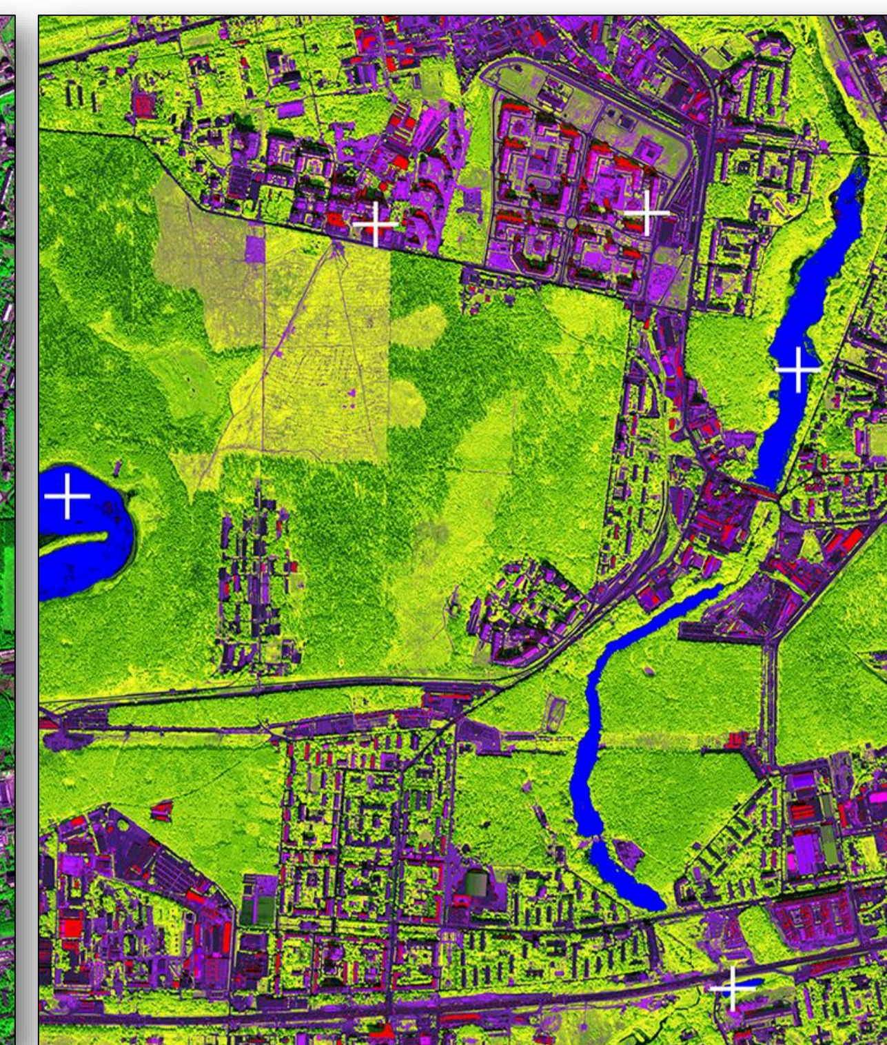
Результат выделения водной поверхности Тени отделены благодаря учету пространственных характеристик
