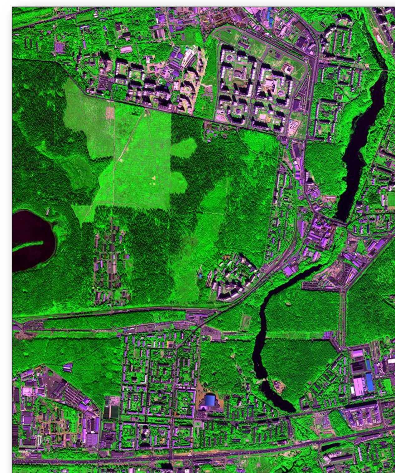
Спутниковый снимок WorldView-3 (1,25 м) Тени не отделяются от водной поверхности по спектральным характеристикам
